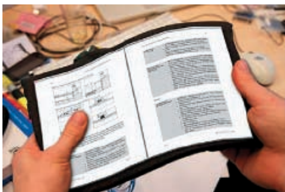
El prototipo de Twend (Twist & Bend) que se desarrolla en Aquisgrán
